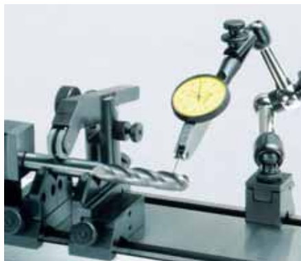
Verificación del error de concentricidad entre el mango y el filo de corte de una fresa
