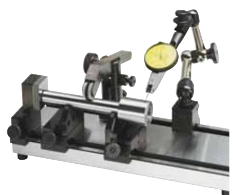
Verificación entre dos diámetros
