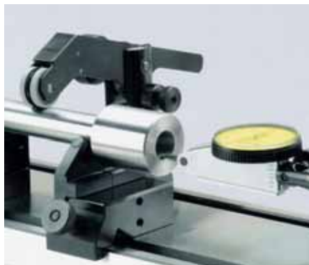
Verificación entre diámetro exterior e interior
