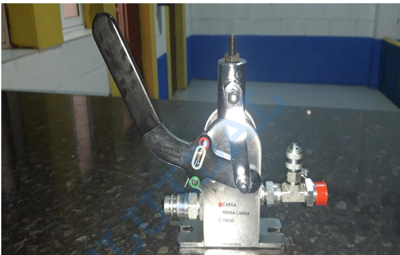
LA VALVULA VFRECVIT, REGULA LA FUERZA DEL CILINDRO DE FRENO SEGÚN NECESIDAD DEL REMOLQUE AGRICOLA Y SEGÚN ESPECIFICACIONES DEL FABRICANTE, CON TRES POSICIONES MANUALES.
