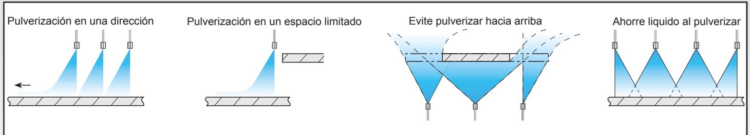
El control de la dirección del flujo en aplicaciones como enfriamiento de placas metálicas se puede conseguir combinando boquillas de pulverización plana estándar con boquillas con pulverización descentrada como las del modelo OVVEP.
