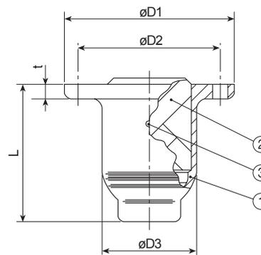
①Cuerpo de la boquilla ②Agitador ③Perno de bloqueo
