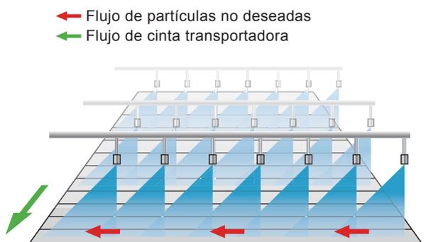
La pulverización en una dirección evita la acumulación de líquido y partículas no deseadas.
