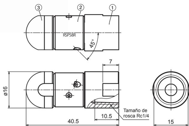
①Adaptador de conexión ②Cuerpo boquilla (parte rotativa) ③Tapa
