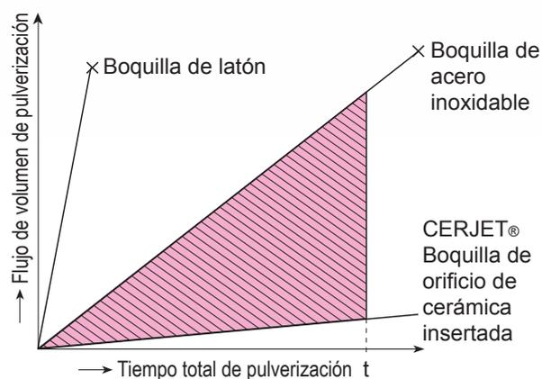
El gráfico muestra el aumento del caudal debido a la erosión de boquillas de distintos materiales. El área sombreada muestra el exceso en el caudal de pulverización de una boquilla con cabezal de acero inoxidable comparada con una boquilla con cabezal CERJET® en función del tiempo (t).
