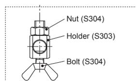
Los componentes enmarcados por línea de puntos son el adaptador de montaje (opcional).
