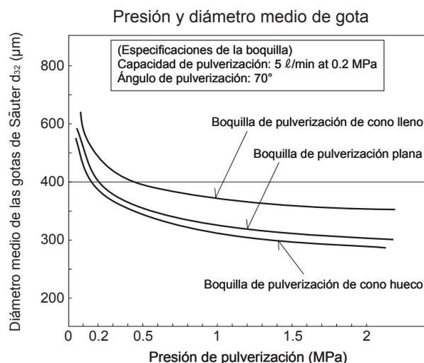
Si la presión, volumen y ángulo de pulverización se mantienen constantes, el tamaño medio de gota de una boquilla de cono hueco es el más pequeño de todas las boquillas hidráulicas.
