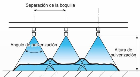
Una manera de combinar múltiples boquillas de distribución uniforme es dando un ángulo de 15 grados al plano de pulverización de cada boquilla con respecto a la línea de ejes donde las boquillas están roscadas.
