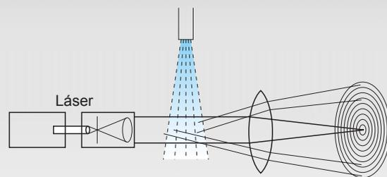
Este método puede medir simultáneamente todas las gotas que interfieren con el rayo láser, pero si la concentración de gotas de la pulverización es muy alta se puede provocar un fenómeno denominado dispersión múltiple en el cual, un rayo difractado por una gota puede volver a ser difractado por otra gota, esto altera la medición haciendo la medida más pequeña de lo que la gota es en realidad.
