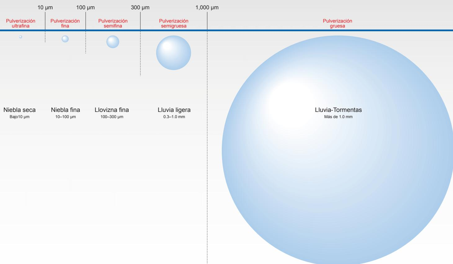
La clasificación mostrada se basa en un tamaño de gota medido por el método de análisis por inmersión\*. Los tamaños medios de gota se han calculado con el modelo matemático Sauter\*\*. Para mediciones realizadas por métodos laser calcular valores correlativos con la siguiente tabla.
