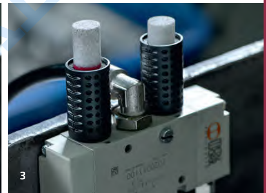
3. La marca de aviso indica que el silenciador debe reemplazarse.
