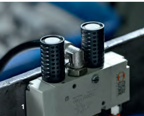
1. La imagen muestra el silenciador en su posición normal.
