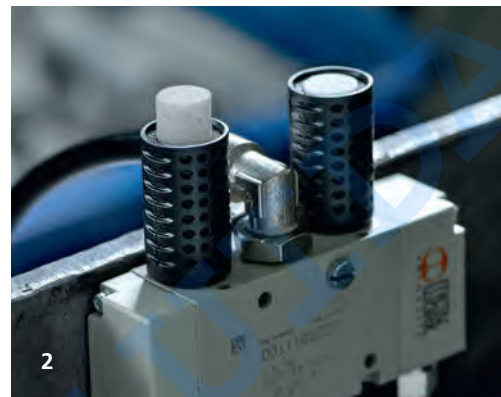
2. El silenciador después de una cierta cantidad de obstrucción.
