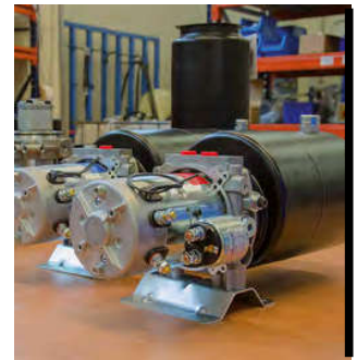
MONTAJE DE MINICENTRAL POWERPACK ASSEMBLY
